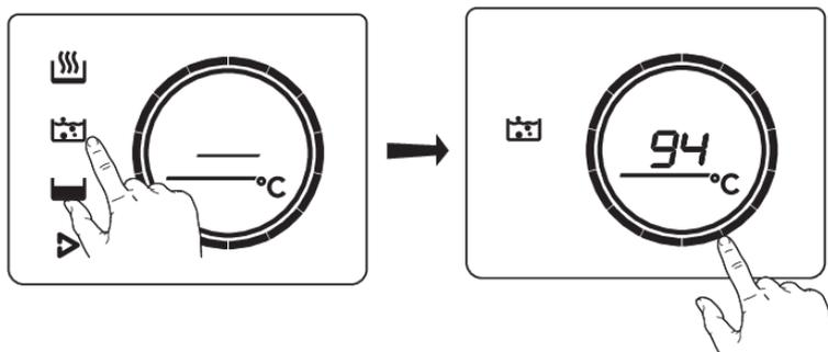
Questa opzione prevede la cottura utilizzando Celsius°Cooking™ (padella o pentola) che misura continuamente la temperatura all'interno della pentola o della sonda di temperatura Celsius°Cooking™. Tutte usano il collegamento Bluetooth per inviare informazioni sulla temperatura al piano cottura.
