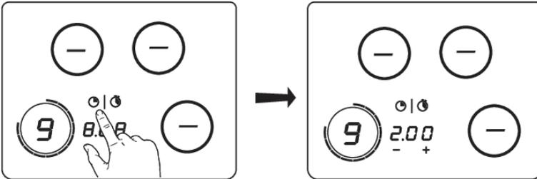
Ogni zona di cottura ha due timer: un timer per il conto alla rovescia e un cronometro (timer contatore).
