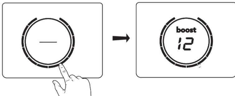
Per una cottura rapida è possibile attivare un boost per qualsiasi zona cottura. Ciò consentirà di riscaldare rapidamente grandi quantità di cibo utilizzando una potenza extra. Il boost sarà attivo per un massimo di 10 minuti; quindi, il livello di potenza verrà automaticamente ridotto a 12. Se il piano cottura non è troppo caldo, il boost può essere riattivato per 10 minuti dopo lo spegnimento.
