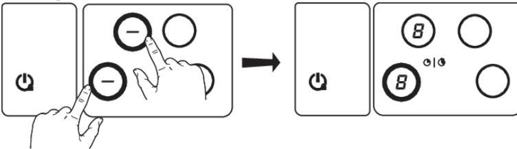
Due zone di cottura quadrate adiacenti possono essere unite in un'unica grande zona di cottura. Il riconoscimento della posizione della pentola si attiva automaticamente all'accensione dell'apparecchio. Quando una pentola verrà posizionata sul piano, la funzione di riconoscimento della pentola riconoscerà la sua posizione e automaticamente collegherà le zone di cottura a seconda delle dimensioni della pentola (solo quando il piano era già acceso).
