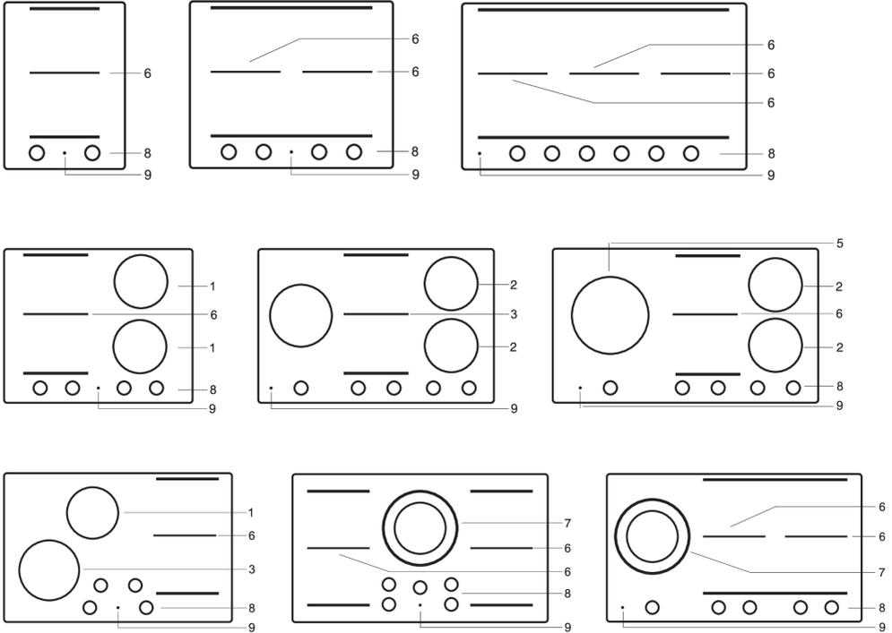
1. Zona di cottura  $\varnothing$  18 cm - 1,85 kW / 3,0 kW (boost)
