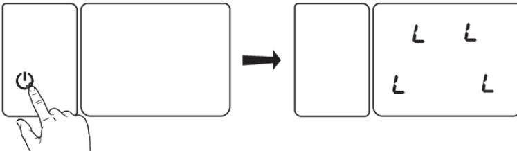
I controlli del piano cottura possono essere bloccati per evitare che questo si accenda inavvertitamente.
