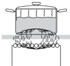
Nell'elettrodomestico si genera un campo magnetico. Posizionando una pentola con una base di ferro su una zona di cottura, viene indotta una corrente nella base della pentola. Questa corrente indotta genera calore nella base della pentola.
